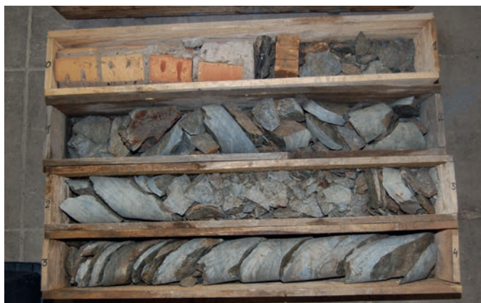
Abb. 2: Bohrkern aus der Tunnelfirste
